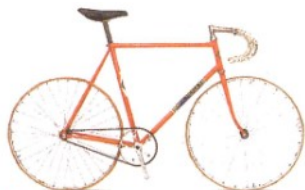
Merckx 1972 Record dell'Ora Telaio in acciaio da 6/10 di millimetro, 48 fori sul manubrio per alleggerirlo
