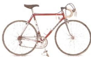
Saronni 1982 Telaio Master In acciaio, ha vinto tutto con Beppe. Per alleggerirlo, il telaio è esagonale
